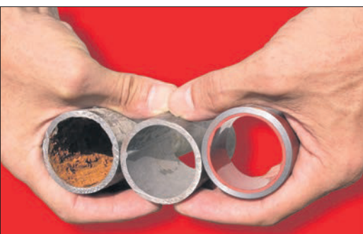
Rostiges, gereinigtes, beschichtetes Rohr.
